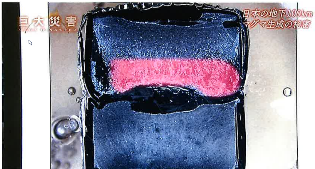
(マグマ生成の秘密 ピンクの部分が溶解してマグマ化している)
